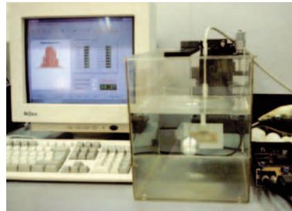
*Der Prototyp eines Elektrosensors*
