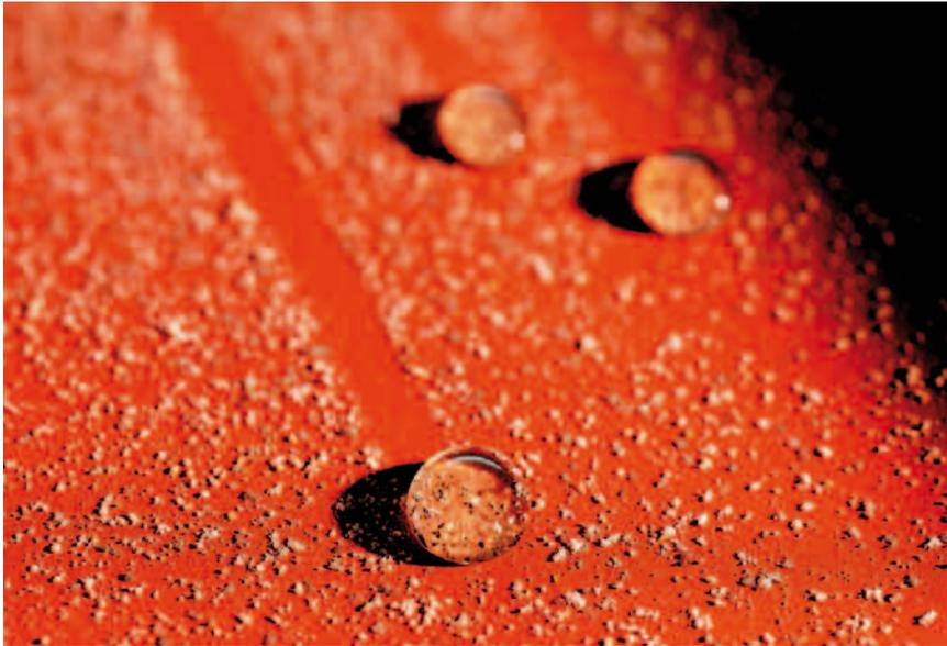
*An mit dem Lotus-Effect® versehenen Oberflächen perlen Flüssigkeiten einfach ab und nehmen den Schmutz gleich mit.*
