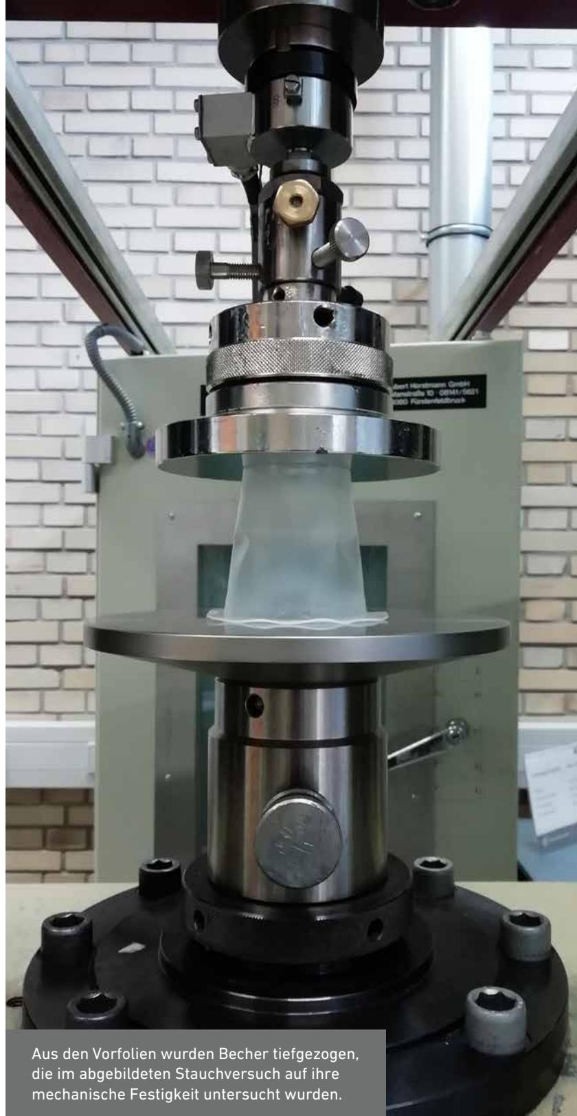
Aus den Vorfolien wurden Becher tiefgezogen, die im abgebildeten Stauchversuch auf ihre mechanische Festigkeit untersucht wurden.
