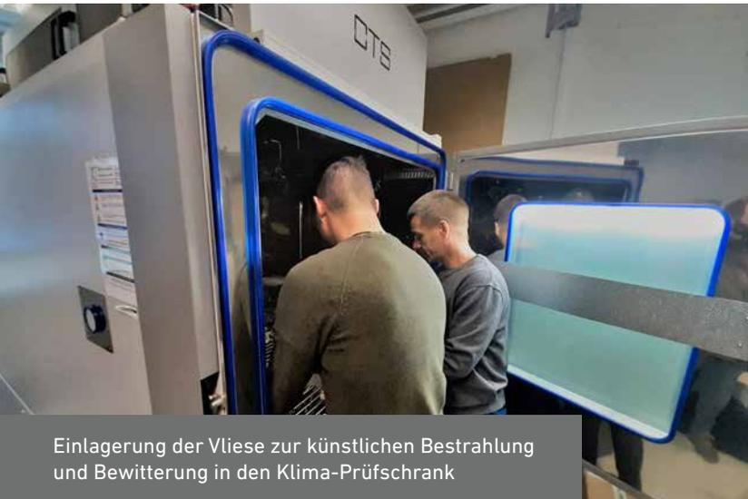
Einlagerung der Vliese zur künstlichen Bestrahlung und Bewitterung in den Klima-Prüfschrank
