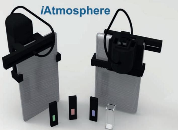
3D-Modell des Smartphone-Spektrometers mit Einwegküvette am Smartphone.
