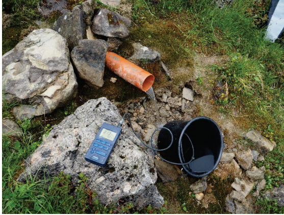
Messung von Schüttung und Leitfähigkeit
