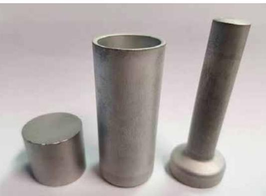
Versuchsteile vor und nach der Umformung
