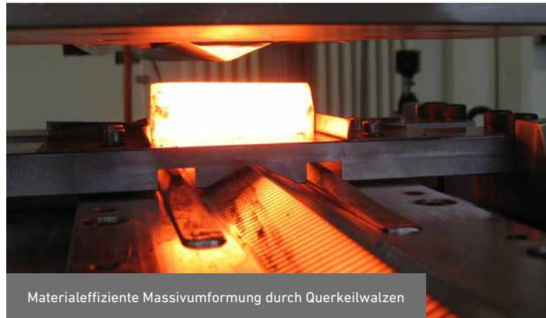
Materialeffiziente Massivumformung durch Querkeilwalzen
