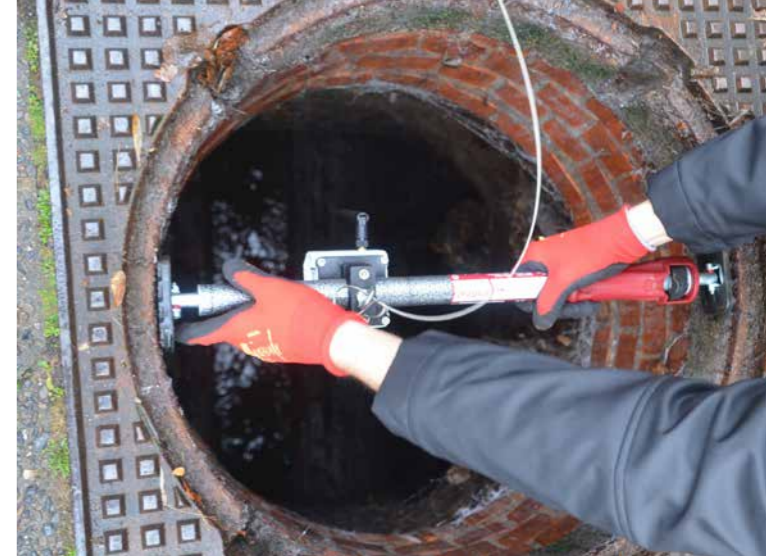
Energieautarke, drahtlos kommunizierende und einfach konfigurierbare Sensorplattform für den Einsatz in Regen- und Abwassersystemen
