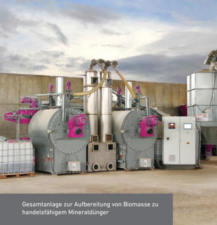
Gesamtanlage zur Aufbereitung von Biomasse zu handelsfähigem Mineraldünger
